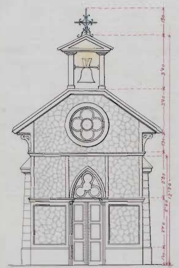
FACHADA DE LA CAPILLA.
