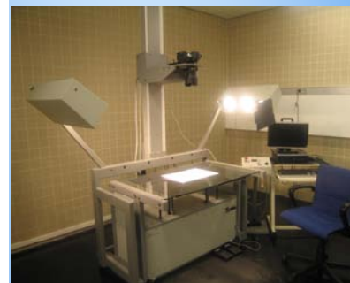
Microfilmadora adaptada para usar una cámara réflex CANON EOS 500D, conectada a un ordenador que tiene instalado el programa de disparo remoto EOS Utility.
