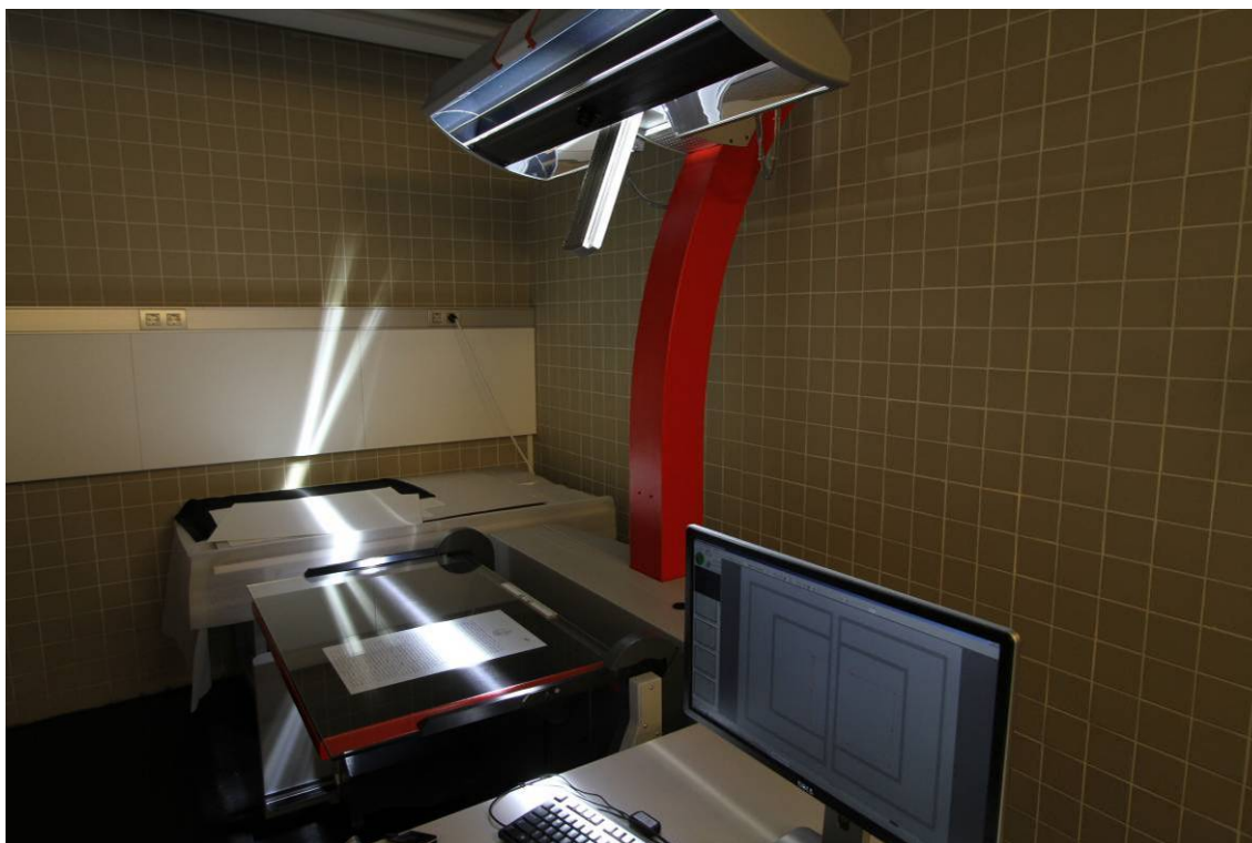
Digitalización de un documento en los talleres del Archivo Regional con un escáner cenital Zeutschel 14.000 OS – A0.
