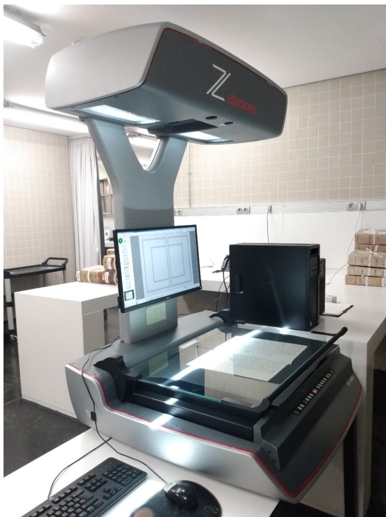
Digitalización de un tomo de protocolo notarial con escáner cenital.
