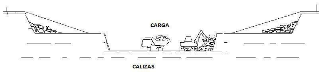
Figura 17. Esquema de desarrollo lateral del banco 2 (inferior).
