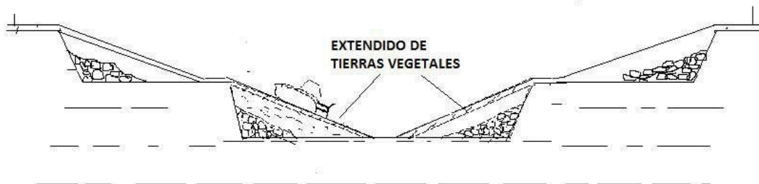
Figura 19. Esquema de extendido de suelos sobre los taludes.
