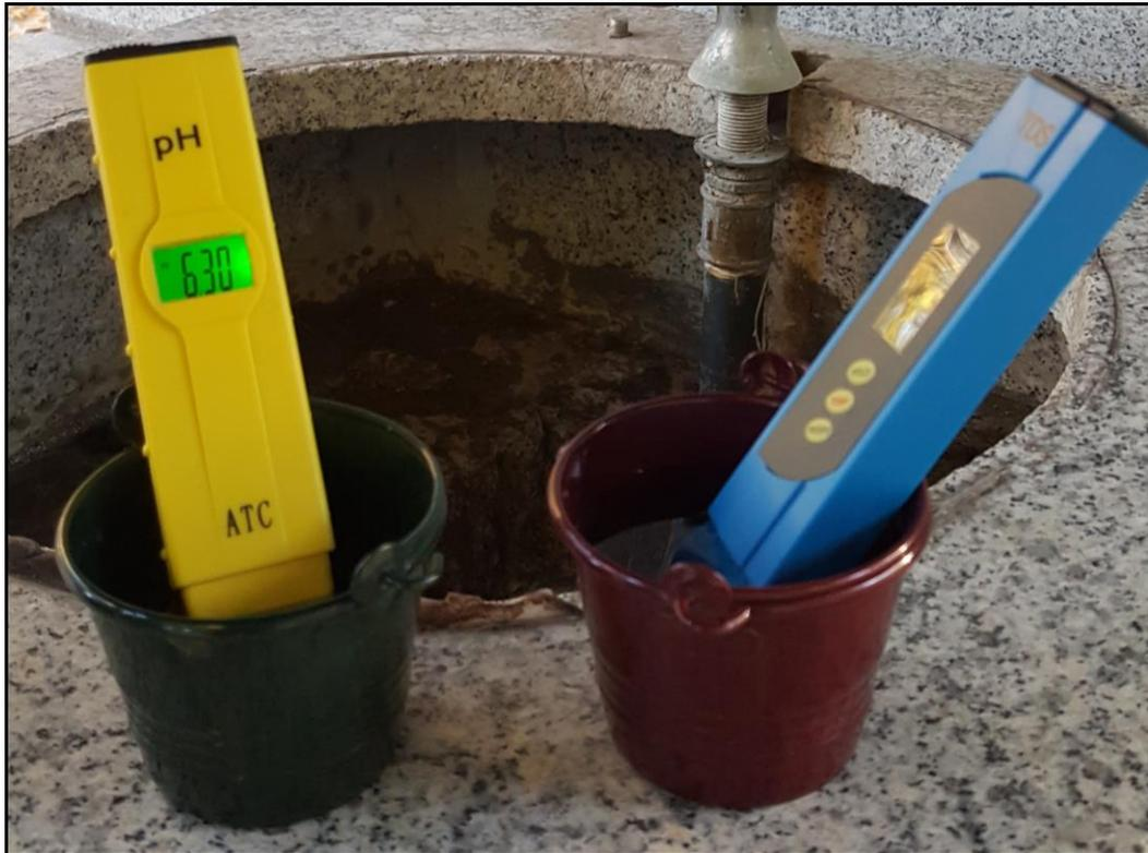
Figura 10: Equipos para medidas de conductividad y temperatura
