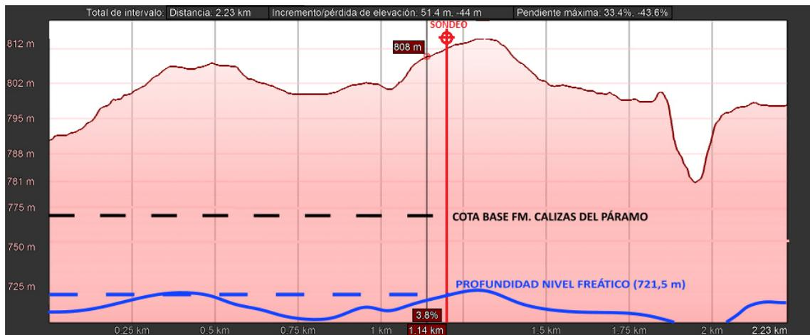
Figura 14: Perfil de elevación del área de estudio y las zonas colindantes con la posición de cota del nivel freático en la actualidad.
