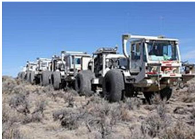
**Figura 12.** Diferentes vehículos utilizados en la adquisición de sismica de reflexión en tierra.
