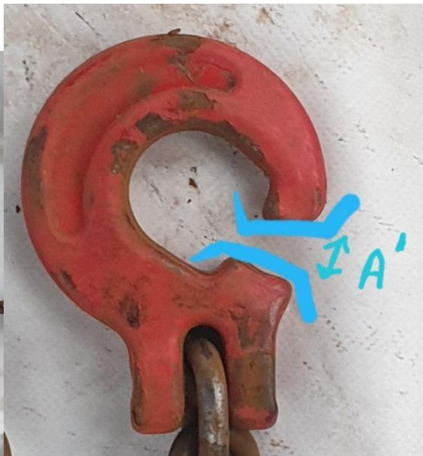
Figura 28: Gancho forestal vs Gancho convencional. ¿Por qué el gancho forestal tiene una apertura proporcionalmente más estrecha y con bordes cuadrangulares A', frente a una apertura amplia y de bordes curvos y suaves en el gancho convencional B'?
