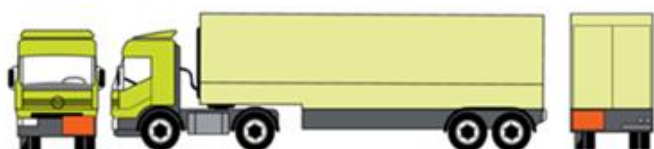
Paneles naranja en un transporte de bultos en un vehículo articulado de caja cerrada.
