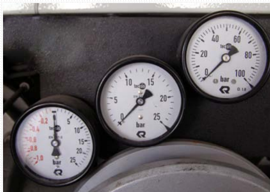
Manovacuometro y manómetros de tubo de Bourdon.
