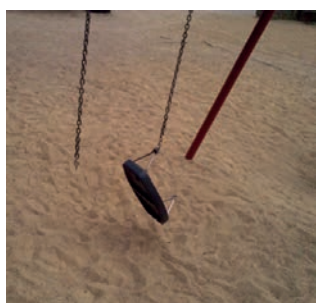
Imagen 191. Rotura de articulación
