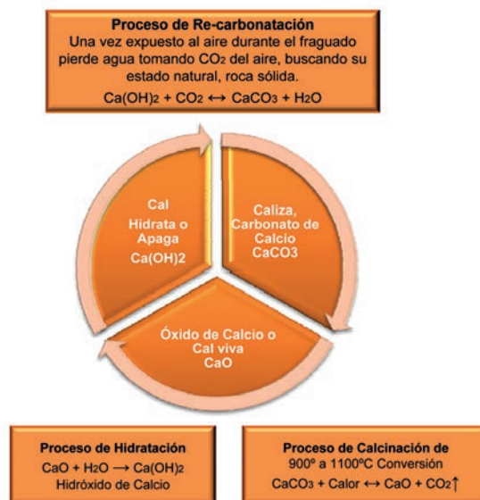
Imagen 55. Proceso de Re-carbonatación / Calcinación / Hidratación
