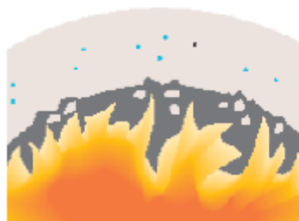
4. Comienza el desgajamiento a medida que el hormigón se deseca localmente.
