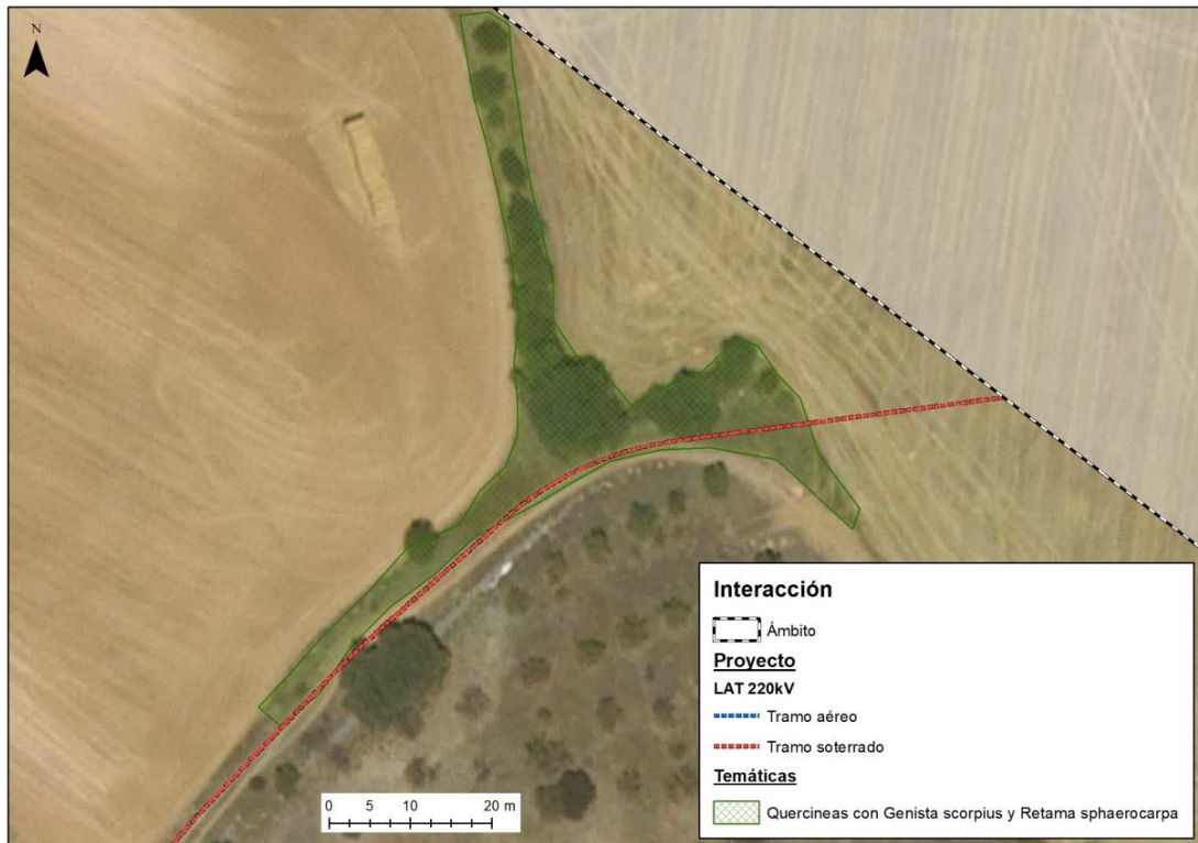
Figura 104. Zona con vegetación natural afectada por la línea soterrada.
