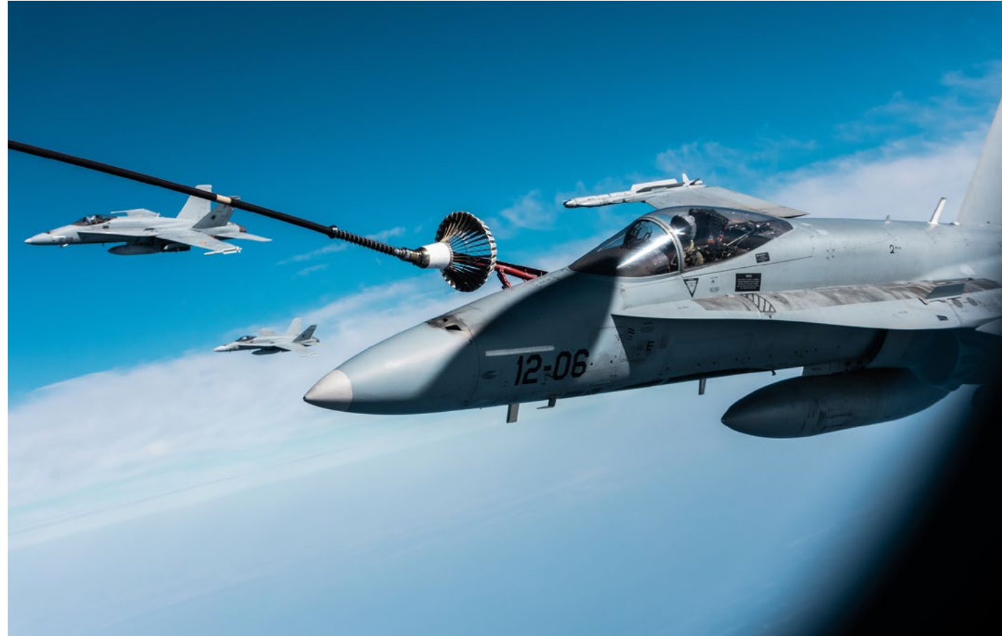
Un F/A-18 Hornet del Ejército del Aire español es reabastecido por un avión cisterna polivalente A400M español en el cielo de las Islas Canarias.
