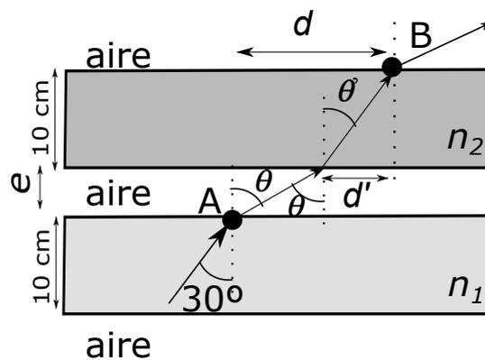
Si ahora aplicamos la ley de Snell en el punto A y en el punto entre el aire y el medio 2, podemos obtener los ángulos de refracción:
