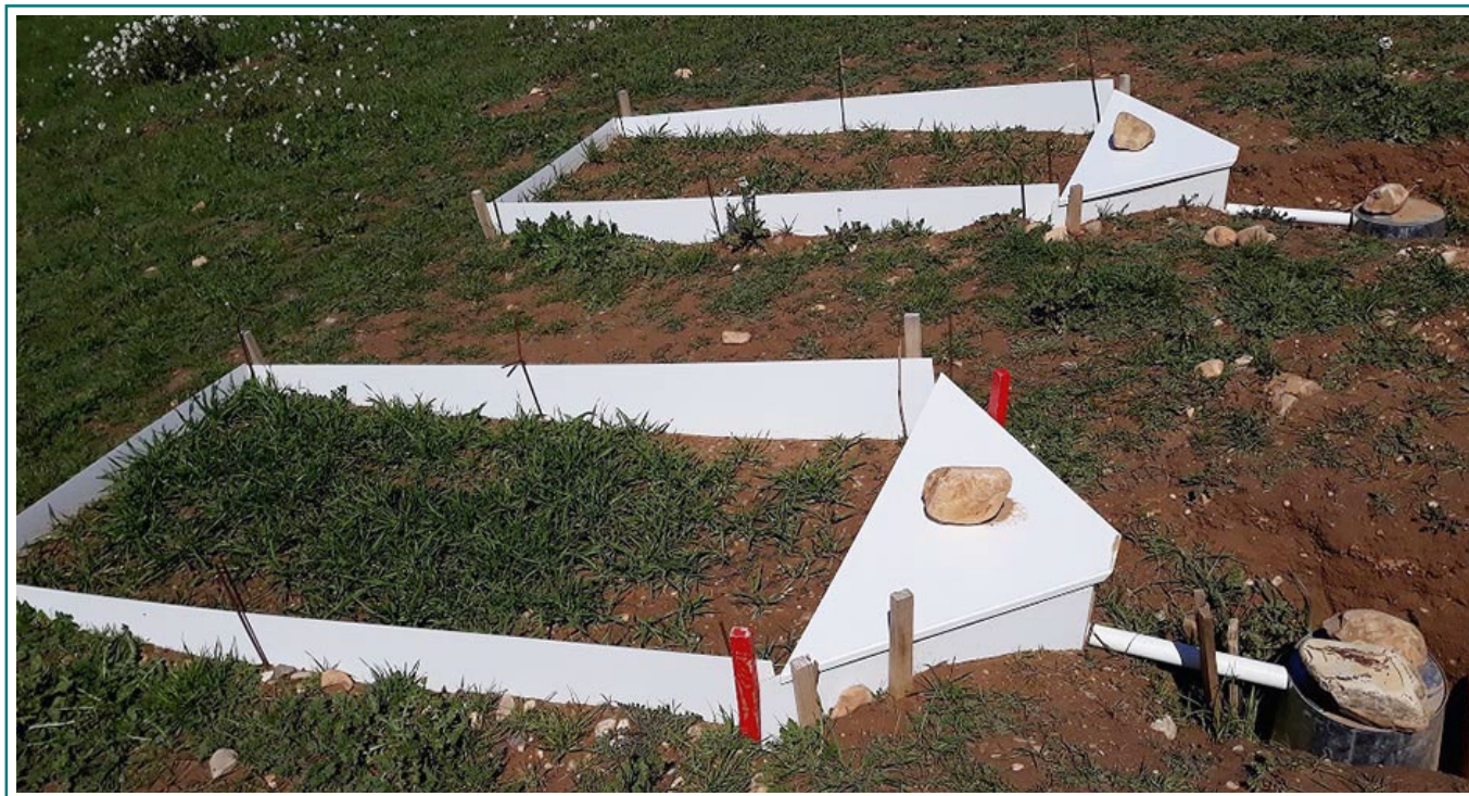
Microparcelas experimentales para el estudio de la aplicación de lodos de depuradora
