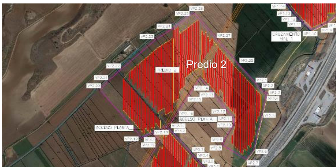
Detalle de las coordenadas de replanteo del vallado del Predio 2 (Fuente: Proyecto básico de la planta solar)
