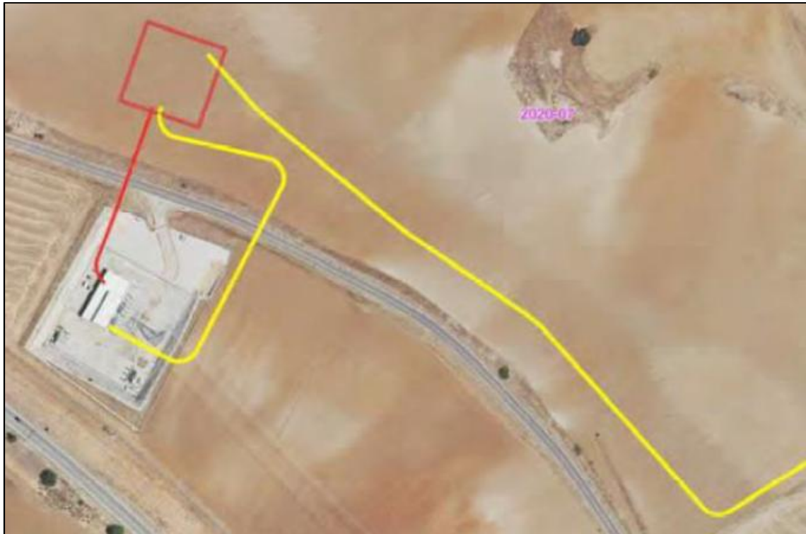
Modificación del trazado de la línea a su entrada a la SET (en amarillo nuevo trazado)
