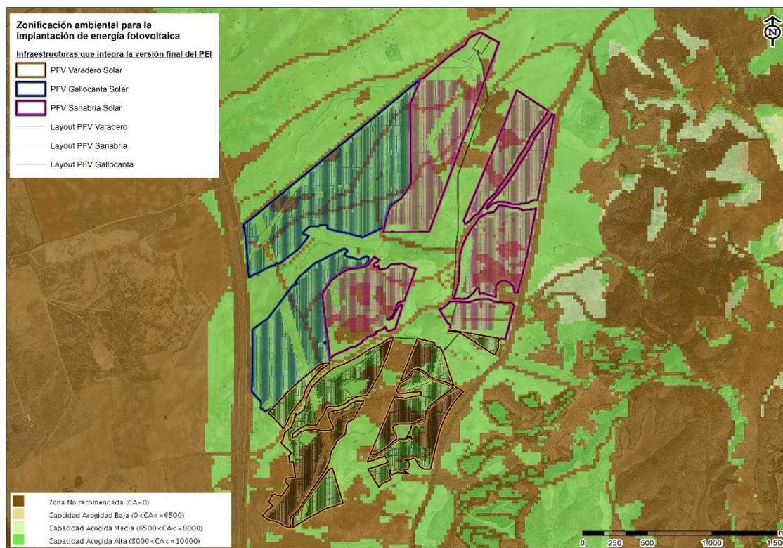
Figura 9. Superposición de la implantación final de las PFV sobre la zonificación ambiental para la implantación de energía fotovoltaica en la Comunidad de Madrid. Fuente: elaboración propia.
