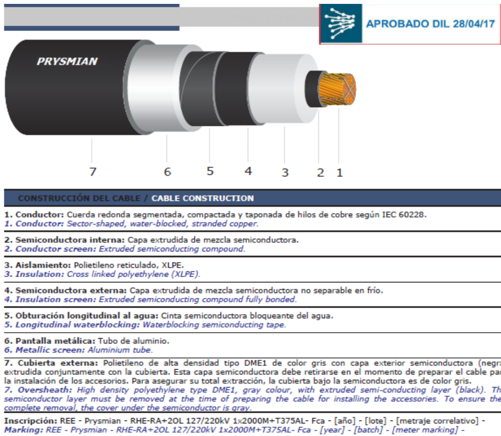
Figura 38: Conductor subterráneo seleccionado 127/220 kv
