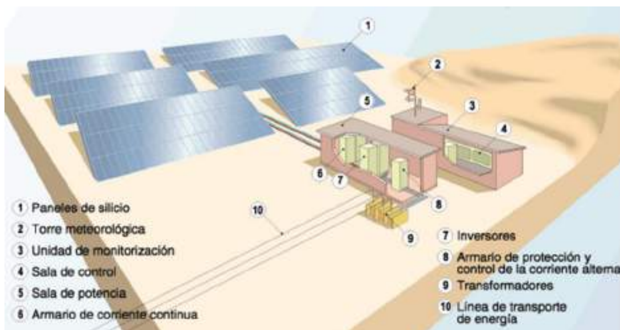
Imagen 1. Funcionamiento tipo - genérico de una Planta Fotovoltaica
