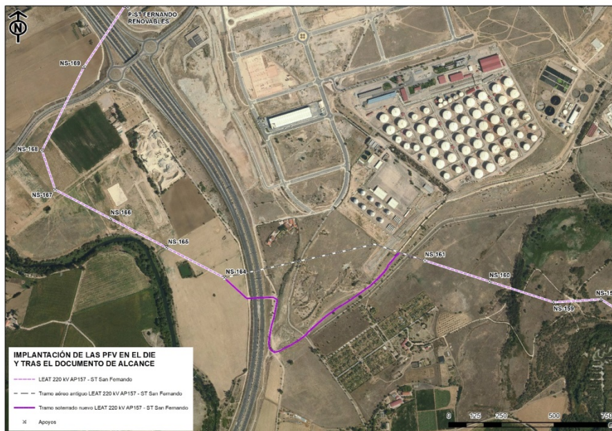
Comparativa entre el trazado inicialmente previsto y el propuesta en la versión inicial del PEI, en San Fernando de Henares.
