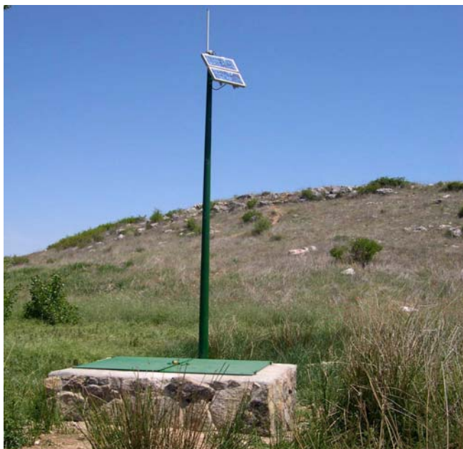
Arqueta y sistema de alimentación del medidor de nitratos en continuo en el manantial de la Fuente del Rey
