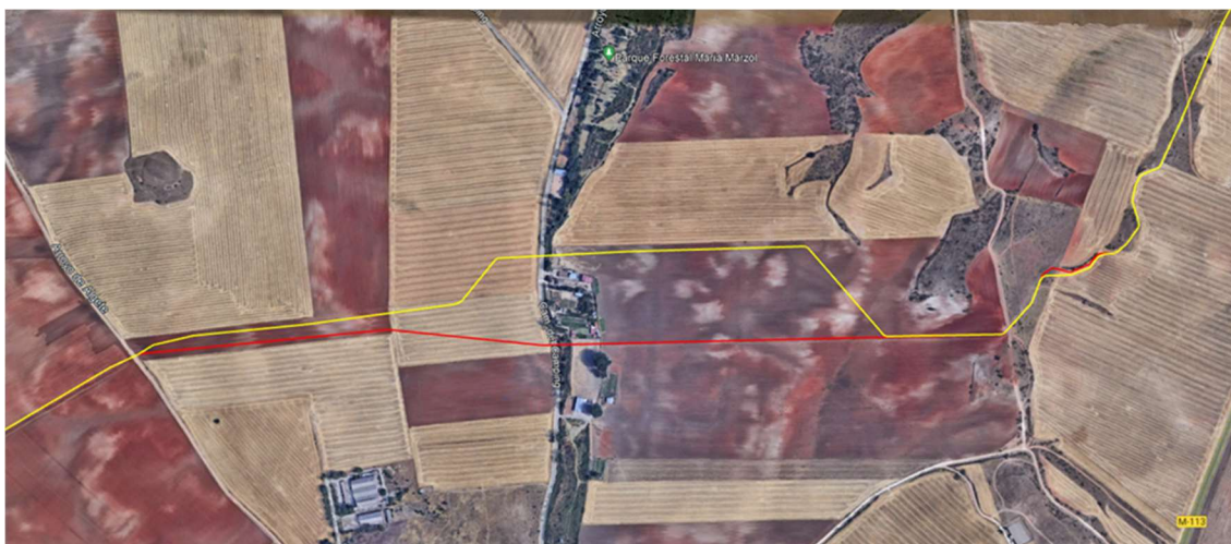
Comparativa entre el anterior trazado del anteproyecto (trazado rojo) y el trazado actual (trazado amarillo) contemplado en el PEI DAGANZO 220kV
