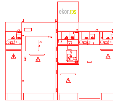
CENTRO DE PROTECCIÓN, MEDIDA Y CONTROL
