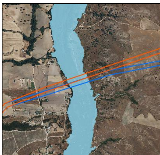
Figura 18: Zona inundable del Río Guadarrama en un período de retorno de 500 años (sombreado en azul) y ámbito del PEI (línea roja) y de la alternativa (línea azul)
