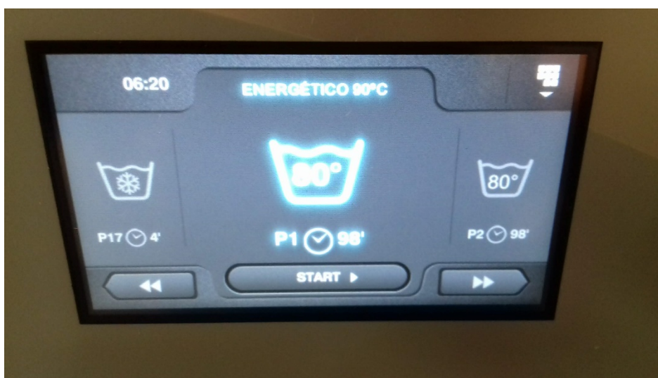
LAVADORA QUE GARANTIZA LA TERMODESINFECCIÓN CON PROGRAMA 1 ENERGÉTICO 90°C
