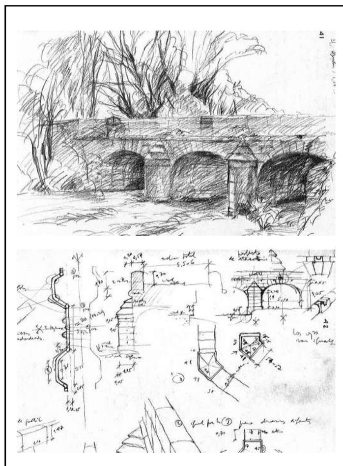
**OBSERVACIONES:** Es imprescindible la restauración del puente con reposición de algunas de las piezas del pretil que faltan, y la recuperación del nivel original del tablero recreado actualmente hasta ocultar una parte importante del pretil, impidiendo la contemplación del elemento en sus proporciones reales.
