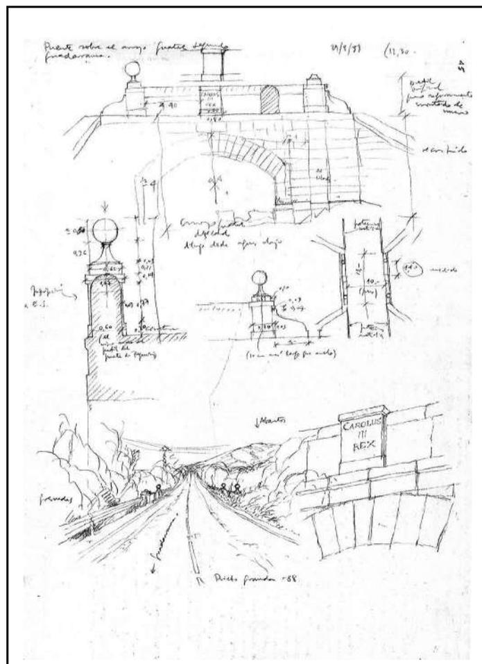
**OBSERVACIONES :** Este puente, aunque conserva gran parte de las piezas y elementos originales, está rehecho y transformado al haberlo trasladado unos metros aguas abajo de su emplazamiento original, a causa de las obras de nuevo trazado para eliminar de la carretera la curva en que se encontraba situado. La descripción del puente corresponde al estado actual. Hay que señalar que se encuentra en notable estado de abandono y que han desaparecido las bolas de remate de las embocaduras.
