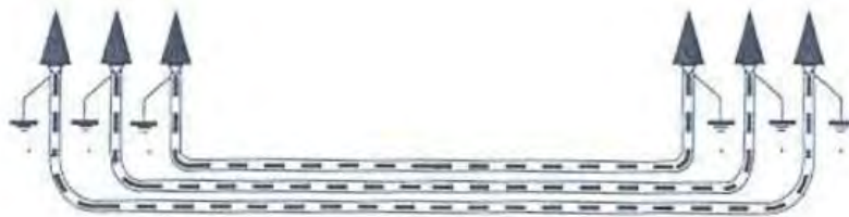
Ilustración 39. Puesta a tierra cubiertas metálicas
