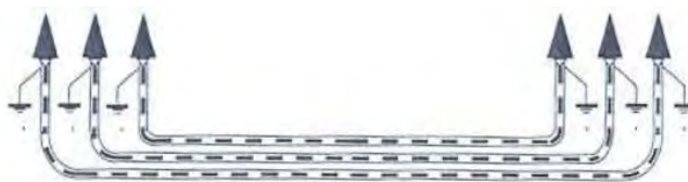
Ilustración 21. Puesta a tierra de cubiertas metálicas
