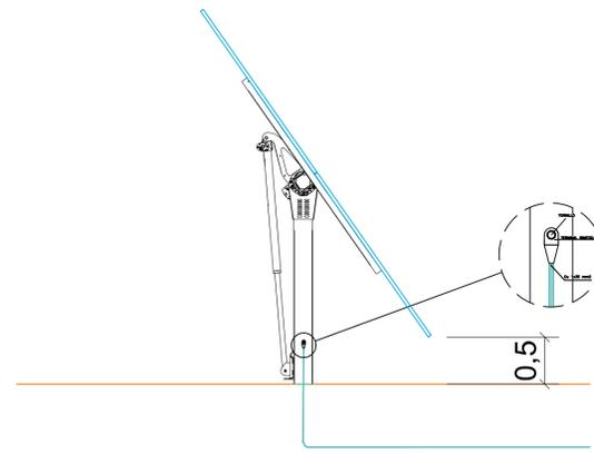
DETALLE PUESTA A TIERRA -CONEXIÓN ENTRE TRACKERS
