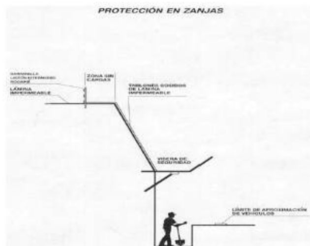
Figura 21: Protección, señalización y entibación de zanjas.
