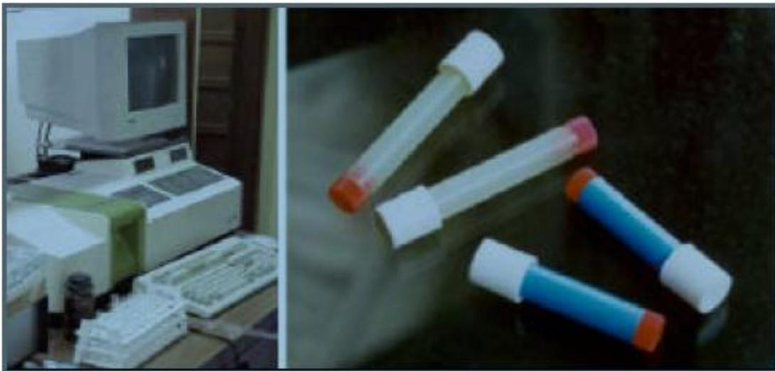
Figura 4. Espectrofotómetro utilizado para el análisis de tubos y ejemplos de tubos captadores (NO<sub>2</sub> los dos de arriba – blancos- y O<sub>3</sub> los dos de abajo – azules-). (Fuente: Manual Radiello).
