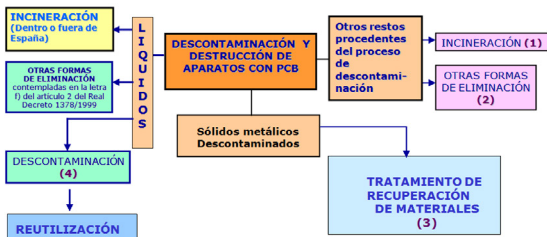
Figura 1. Proceso de tratamiento de aparatos con PCB
