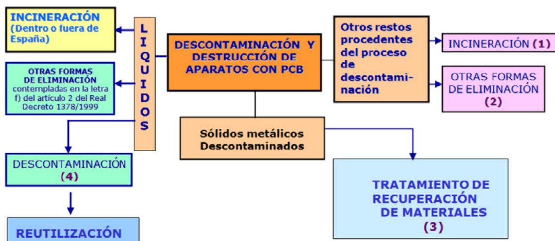
Figura 1. Proceso de tratamiento de aparatos con PCB
