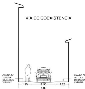
Ilustración 101: Sección de viario de coexistencia
