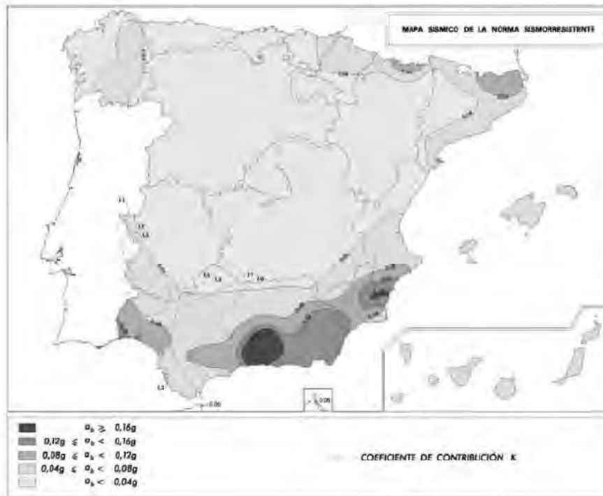
Mapa de Peligrosidad Sísmica. Fuente: REAL DECRETO 997/2002, de 27 de septiembre, por el que se aprueba la norma de construcción sismorresistente: parte general y edificación (NCSR-02).
