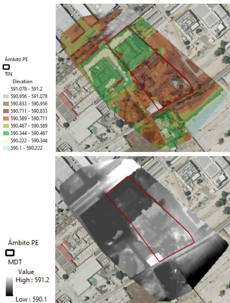
Figura 18. Izquierda: representación TIN. Derecha: modelo digital del terreno. Fuente: elaboración propia.
