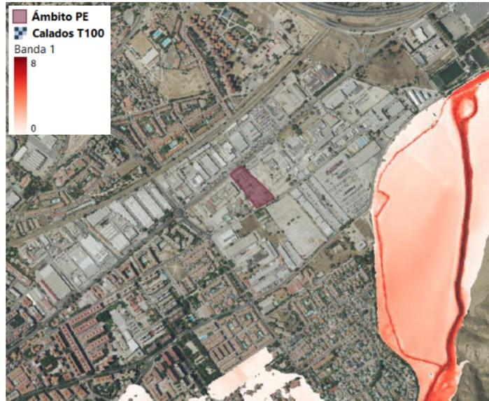
Figura 13. Calados simulados para inundación por el río Henares en un periodo de retorno de 100 años. Fuente: CHT.
