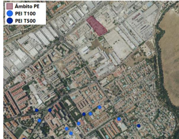
Figura 11. Puntos de Especial Importancia afectados por riesgo de inundación del río Henares. Fuente: CHT. Otra información que proporciona la confederación es el calado obtenido en cada uno de los escenarios de inundación. Esta información es la que se emplea para la realización de los mapas de peligrosidad, por lo que se puede ver una relación entre los siguientes calados y la peligrosidad de inundación representada para cada periodo de retorno.
