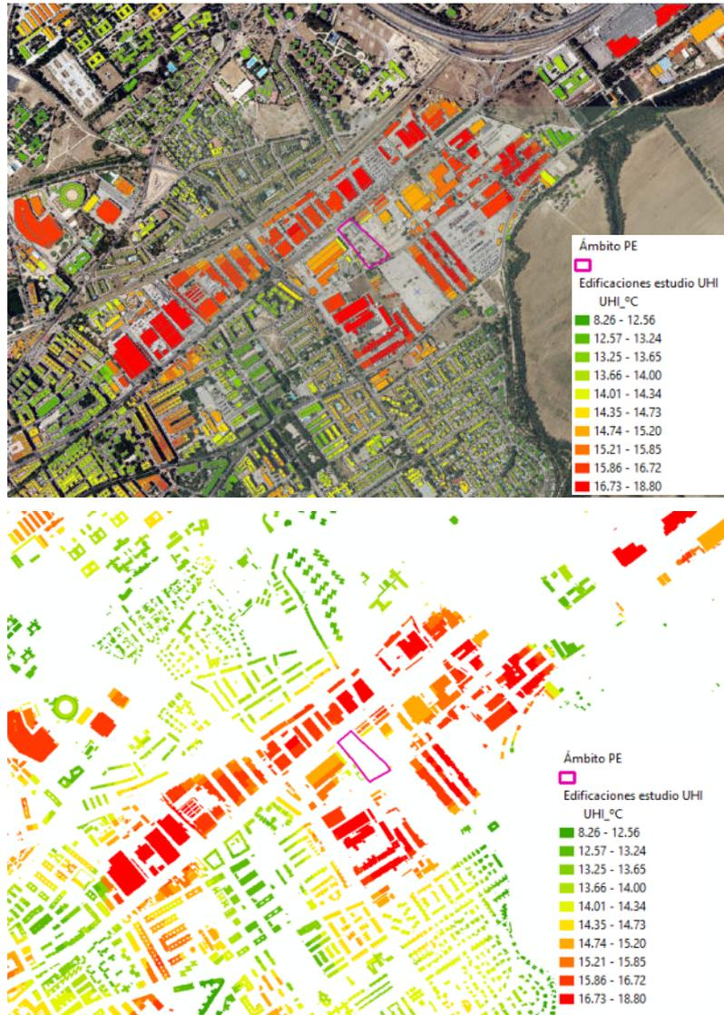
Figura 41. Temperaturas extraídas a las edificaciones. Arriba: sobre ortofoto. Abajo: sin ortofoto. (Fuente: elaboración propia).
