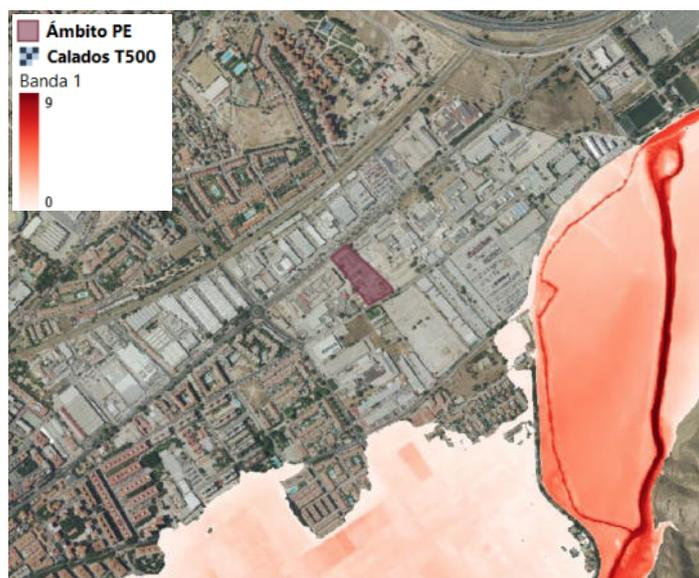
Figura 14. Calados simulados para inundación por el río Henares en un periodo de retorno de 500 años. Fuente: CHT.
