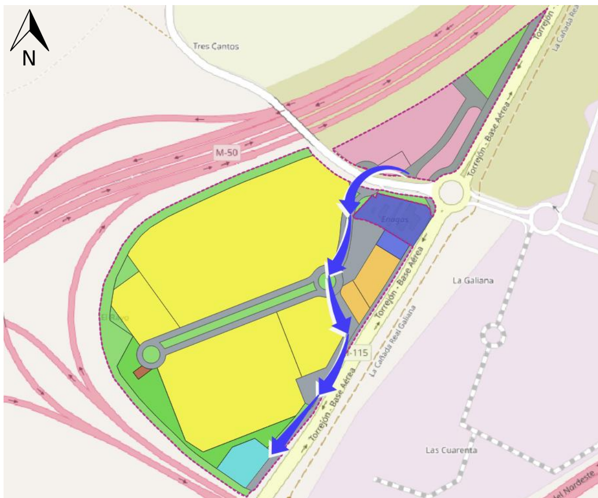
Camino previsto del caudal de pluviales cuenca norte hasta punto de recogida en cuenca sur
