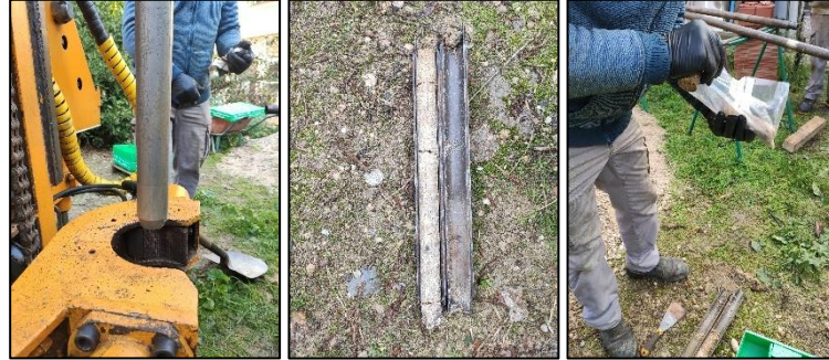
Figura 7. SPT (estándar penetración test). Fuente AENOR. UNE 103.800:92.
