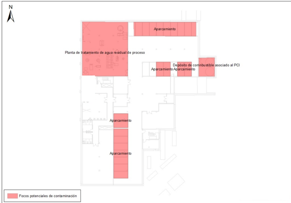
Figura 13.6 Fuentes potenciales de contaminación del suelo identificadas en la planta sótano
