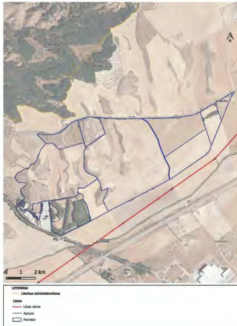
Figura 39. Modificación del trazado de la LEAT para evitar Suelos No Urbanizables de Protección Especial. Fuente: IGNIS.
