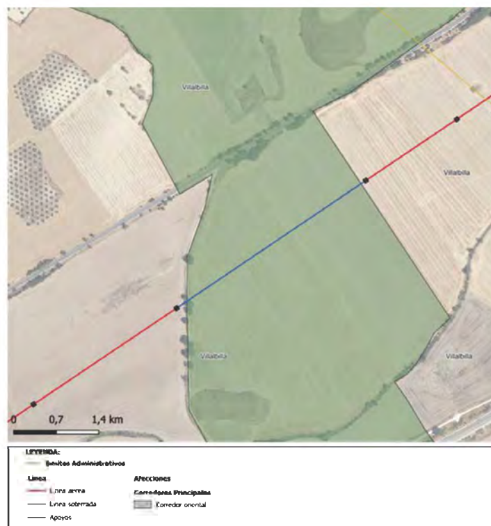
Figura 2. Soterramiento del tramo de la línea en su zona de coincidencia con el Corredor Ecológico Oriental. Fuente: RH Estudio.
