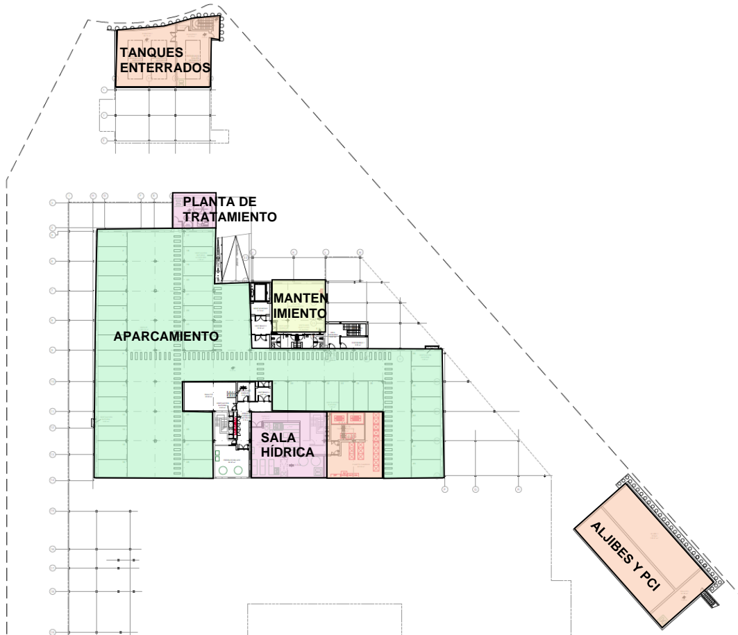
Figura 2.9 Implantación en la planta farmacéutica en planta sótano según la alternativa B.2.1.1.b
