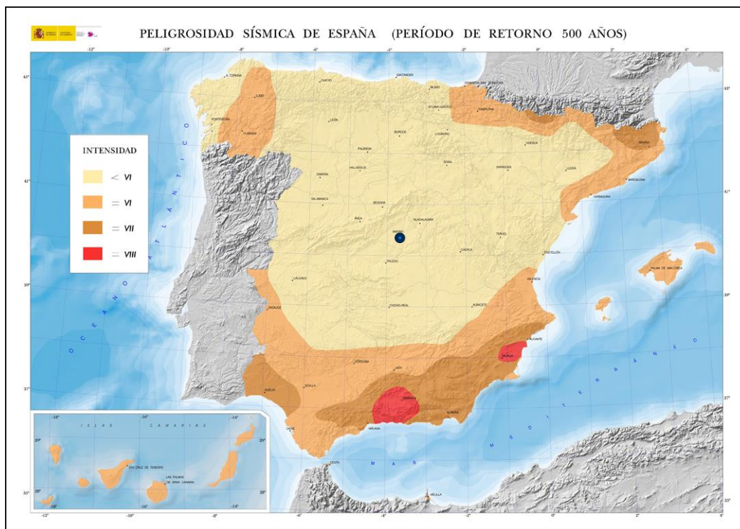
Ilustración 6. Actividad sísmica en el ámbito de la fábrica de Sylentis. Fuente: elaboración propia a partir de los datos del IGN (Instituto Geográfico Nacional)
