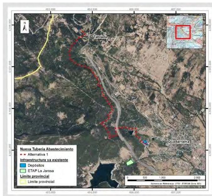
Figura 3. Descripción de las actuaciones Alternativa 1. Fuente: elaboración propia a partir de la cartografía del Plan Especial de Abastecimiento a Tablada T.M. de Guadarrama.
