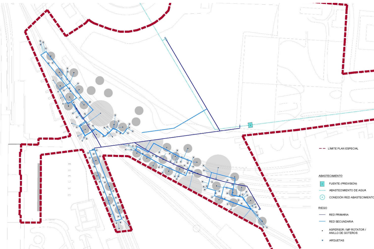
Plano O.11 - Abastecimiento y Riego - Detalle.
