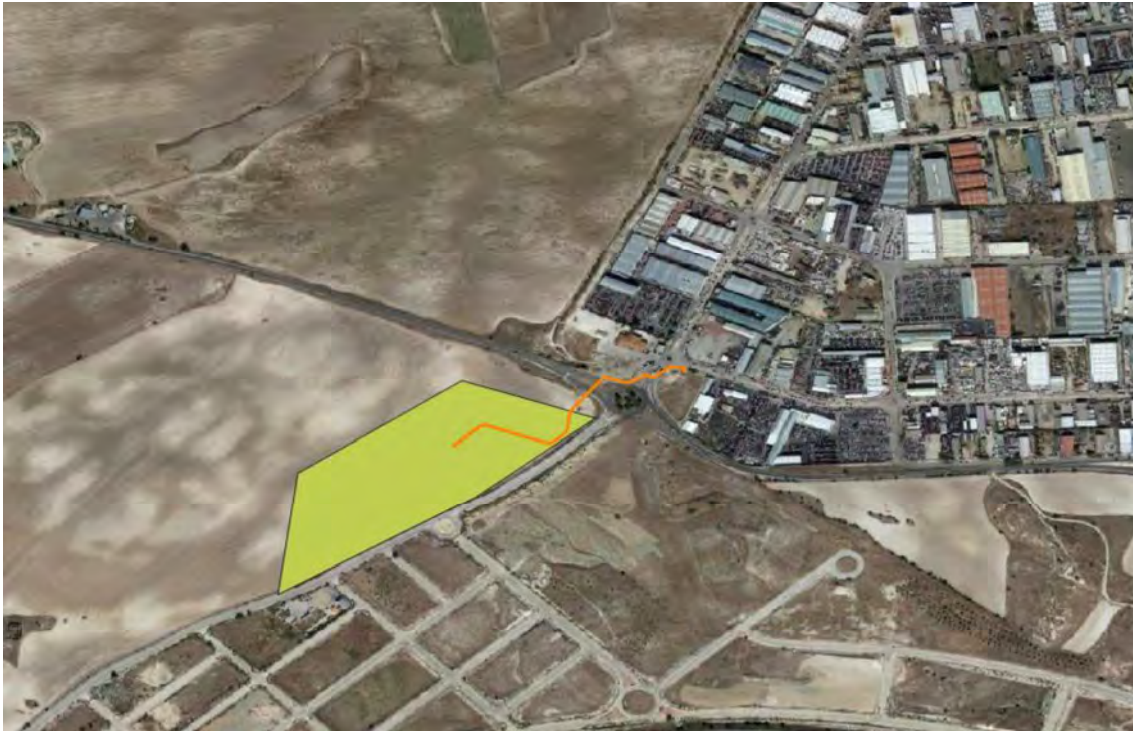
Imagen 4. Layout de la alternativa 1 para "Majuelo" y su línea eléctrica de evacuación.
