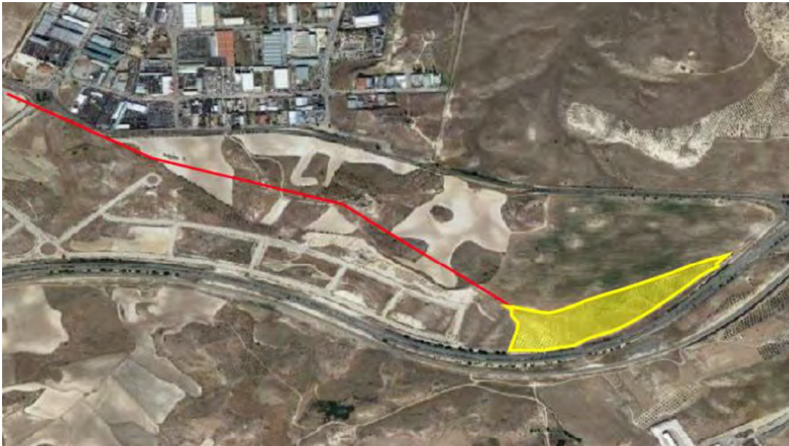
Imagen 9. Layout de la alternativa 3 para "Pradonuevo" y su línea eléctrica de evacuación
