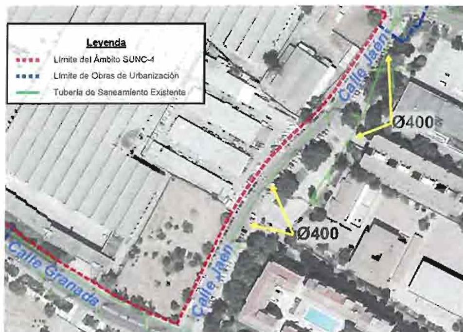
Vista de la Red de Saneamiento existente en la Calle Jaén
