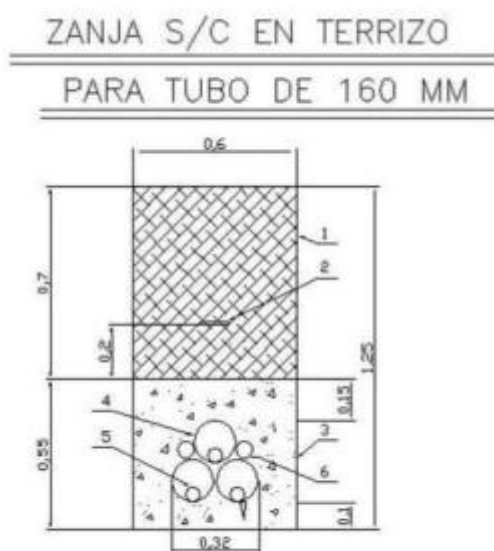
Figura 8. Tipo de zanja
