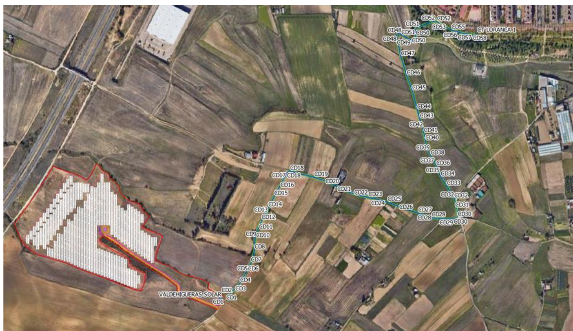
Figura 9.- Layout línea subterránea
