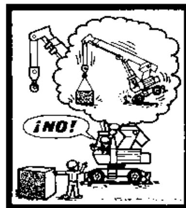
No sobrepasar la carga máxima de utilización, que debe estar bien visible, para los montacargas, grúas y demás aparatos de elevación.
