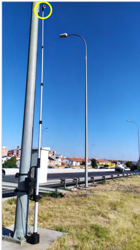
Figura 18. Cámara empleada en la realización de aforos.
