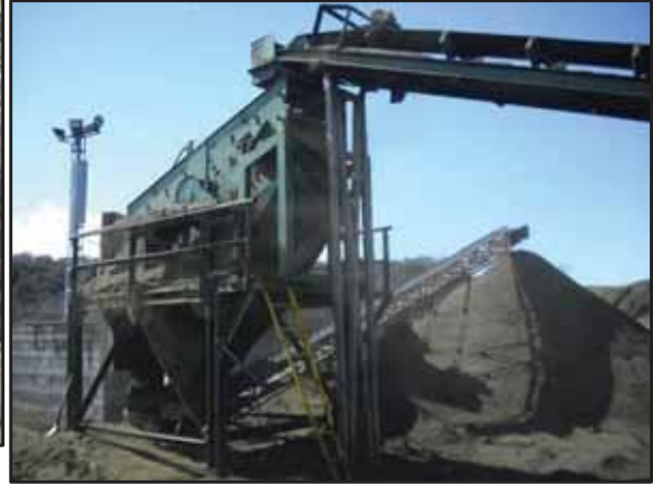
Figuras 19 y 20: Vista general del sistema de cribado (izquierda) y criba mecánica (derecha). Fuente: Elaboración propia.
